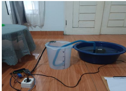
Gambar 4. Pengujian Sistem Mendeteksi Air Kosong
