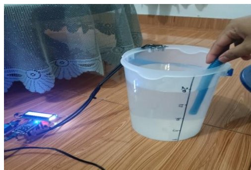
Gambar 5. Sensor Ultrasonik Mendeteksi Air Penuh dan Mesin Dimatikan
